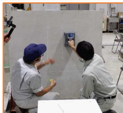
電磁波レーダ法による鉄筋探査
